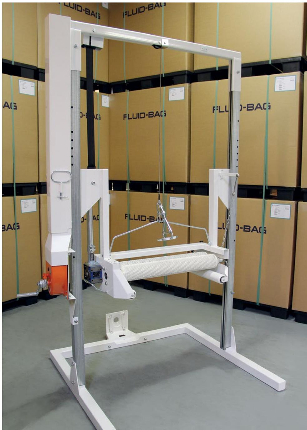
*Rodillo de descarga manual (en la fotografía se muestra con el equipo de protección necesario para uso en exteriores).*
